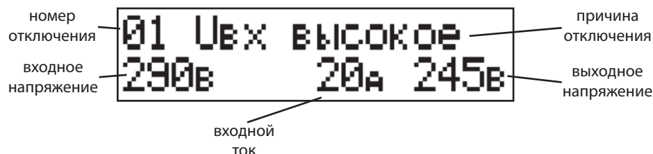
Рисунок 8б. Вид ЖК-индикатора в режиме просмотра журнала защитных отключений
