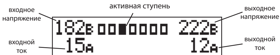
Рисунок 5. Вид ЖК-индикатора в режиме ступенчатого регулирования
